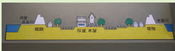
輪中を横から見たイメージ図（輪中の郷提供）
