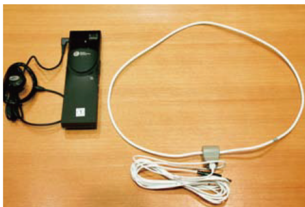
写真の左はイヤホン付受信機、右は受信機に接続するタイループ
