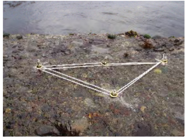
写真2 コンクリートブロック上に設置した種糸
