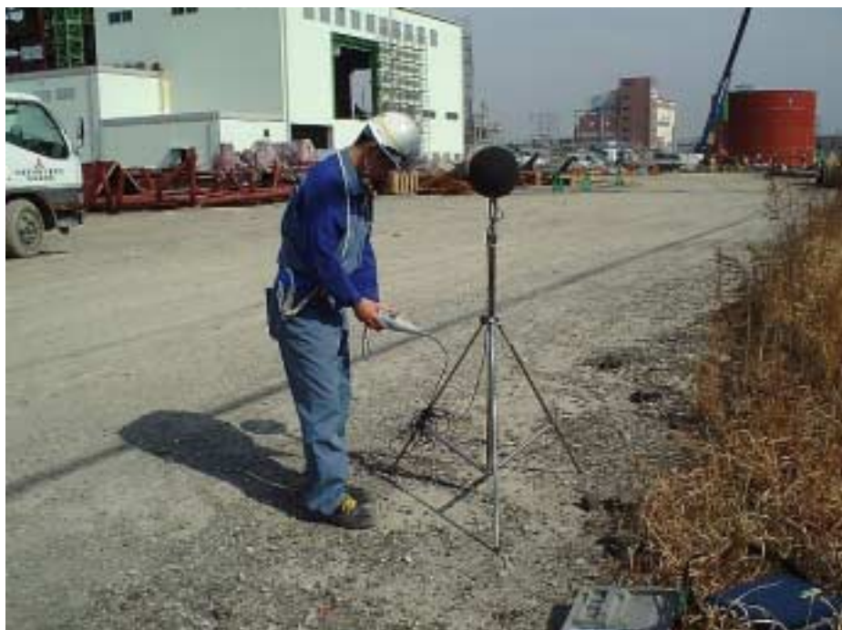
写真 - 3 騒音測定状況（東側敷地境界） 平成 14 年 3 月 14 日
