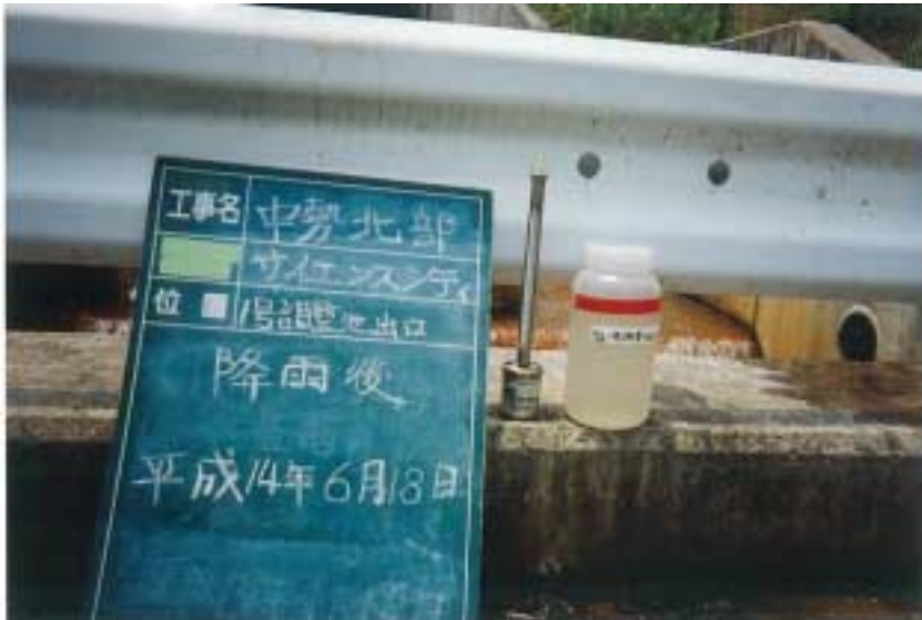
写真4 - 6 - 5 濁水調査状況 (通常降雨時) (1号調整池出口) (平成14年6月18日)
