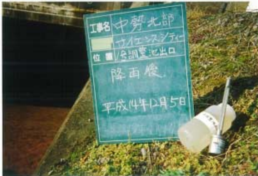
写真4 - 6 - 25 濁水調査状況（通常降雨時）（1号調整池出口）（平成14年12月5日）
