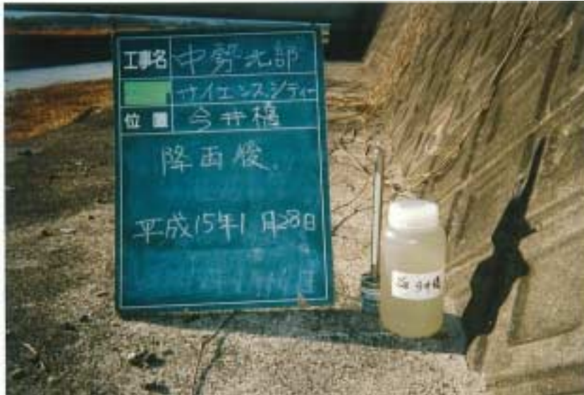
写真 4 - 6 - 31 濁水調査状況（豪雨時）（今井橋）（平成 15 年 1 月 28 日）
