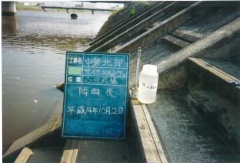
写真4 - 6 - 20 濁水調査状況（豪雨時）（志登茂橋）（平成14年10月2日）
