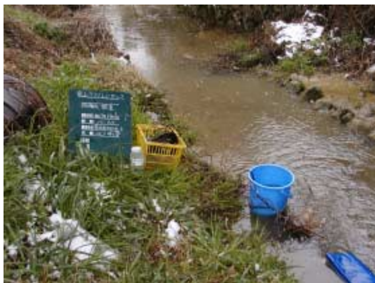
写真 2 - 2 - 2 濁水調査状況 (最終仮沈砂池 b) (平成 15 年 3 月 4 日)
