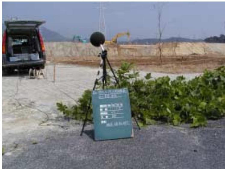
写真3 - 1 騒音・振動調査状況（敷地境界 1）(平成14年8月26日)
