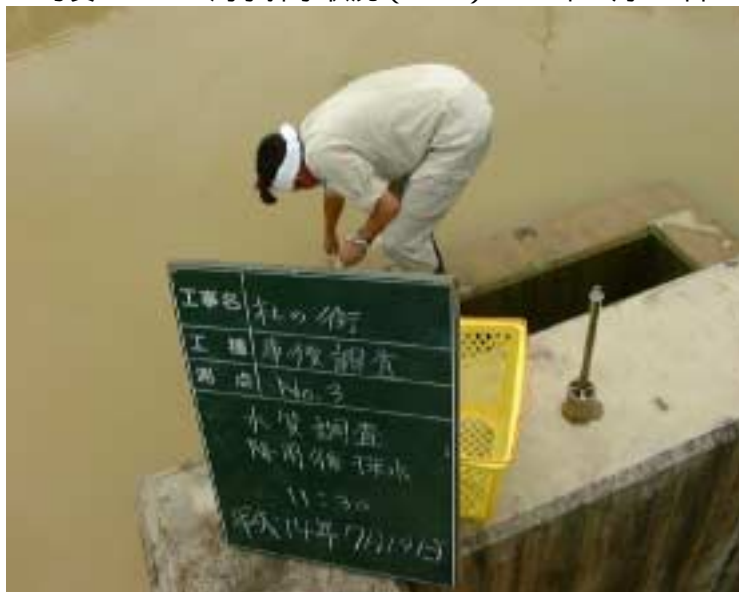
写真3 - 24 濁水採水状況 ( 3 ) H14年7月19日
