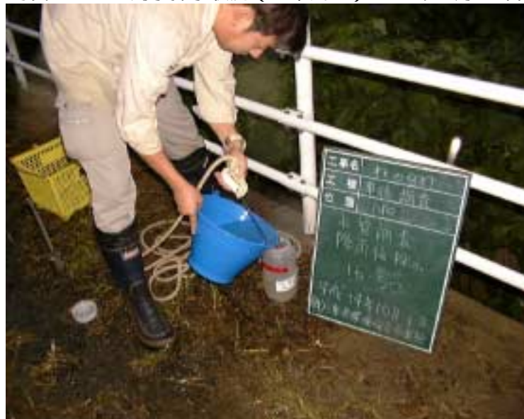
写真3 - 29 濁水採水状況 ( 1 ) H14 年 10 月 1 日
