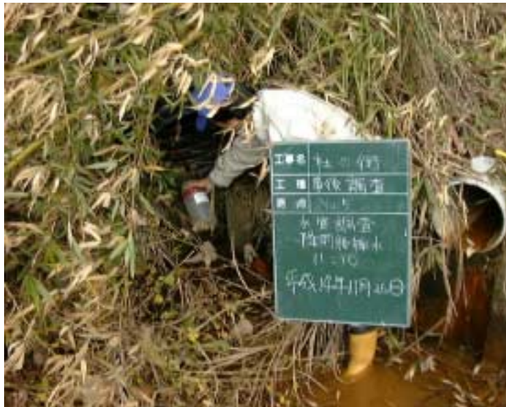
写真3 - 40 濁水採水状況 ( 5 ) H14年11月26日
