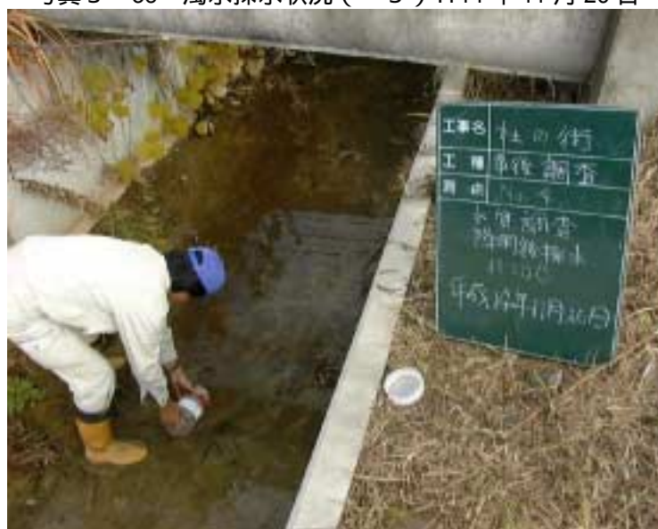
写真3 - 39 濁水採水状況 ( 4 ) H14年11月26日
