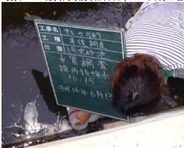
写真3 - 15 濁水採水状況（ 1 ）H14年6月13日
