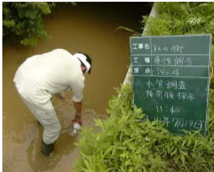
写真3 - 25 濁水採水状況 ( 4 ) H14年7月19日
