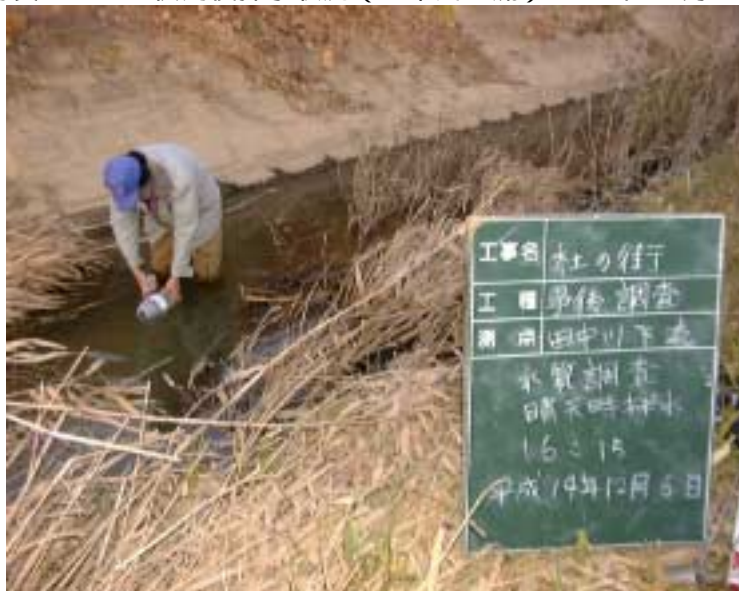
写真3 - 50 供用後採水状況（田中川下流）H14年12月6日
