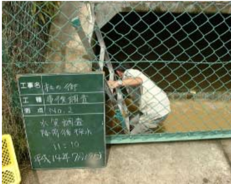
写真3 - 23 濁水採水状況 ( 2 ) H14年7月19日
