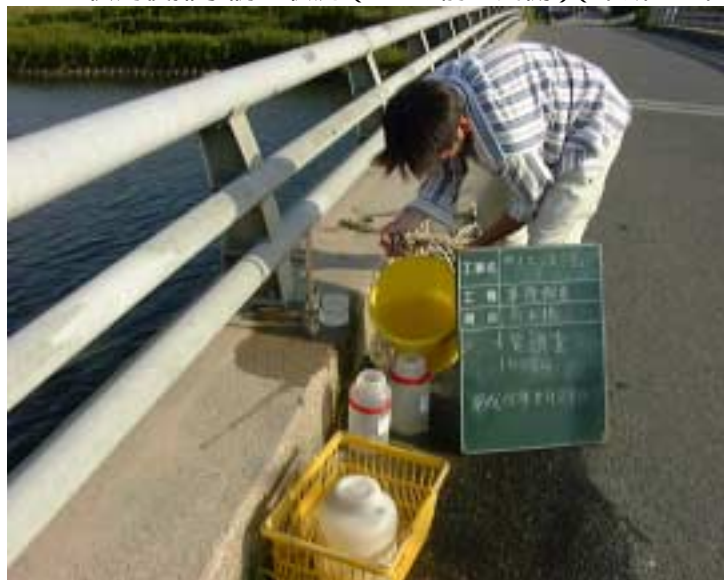
写真 4 - 6 - 35 供用後排水調査状況（今井橋）（平成 15 年 5 月 29 日）
