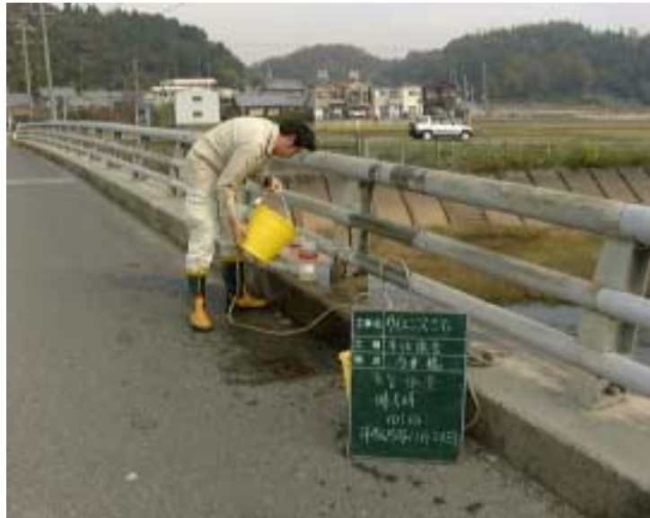
写真 4 - 6 - 47 供用後排水調査状況（今井橋）（平成 15 年 11 月 28 日）
