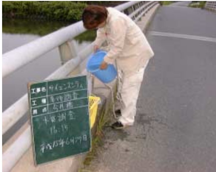
写真4 - 6 - 37 供用後排水調査状況（今井橋）（平成15年6月27日）
