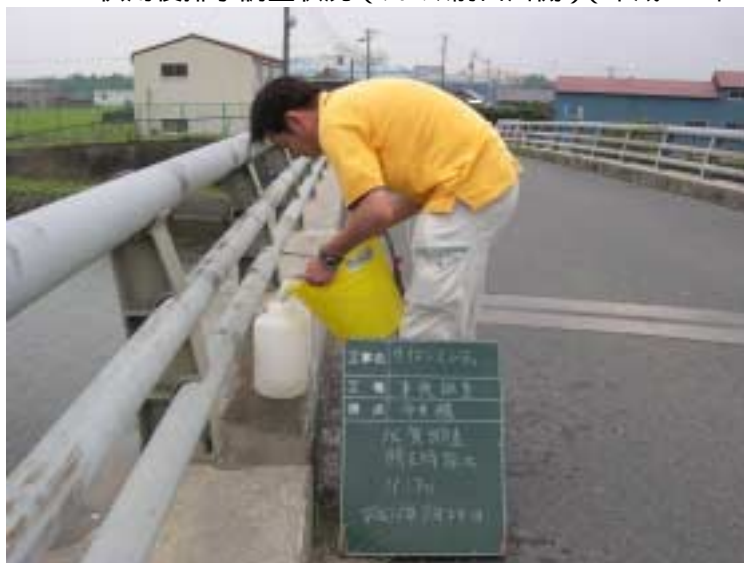
写真4 - 6 - 39 供用後排水調査状況（今井橋）（平成15年7月29日）
