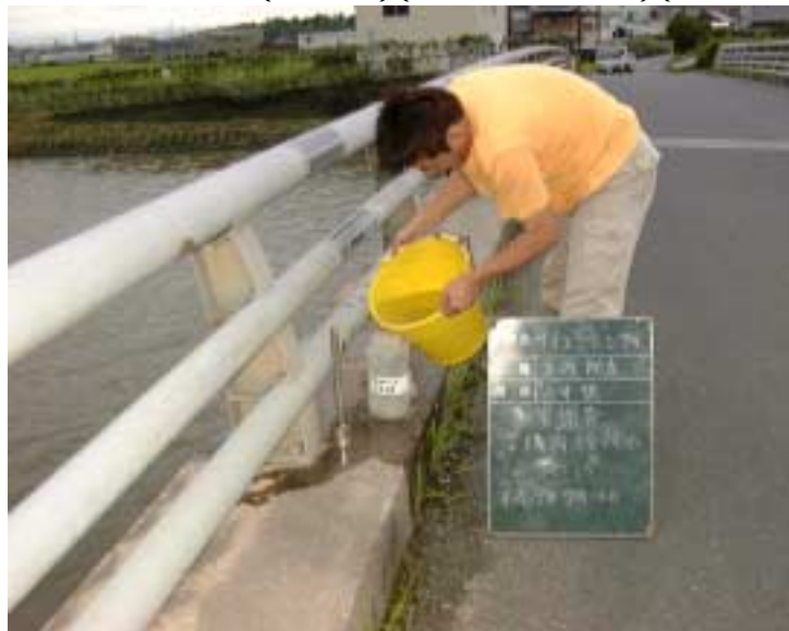
写真4 - 6 - 15 濁水調査状況(豪雨時)(今井橋)(平成15年7月14日)
