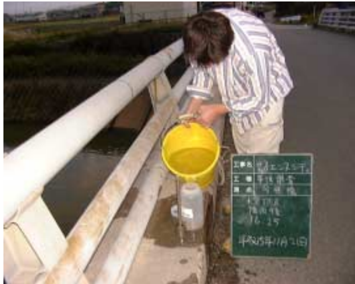
写真4 - 6 - 31 濁水調査状況(通常降雨時)(今井橋)(平成15年11月21日)
