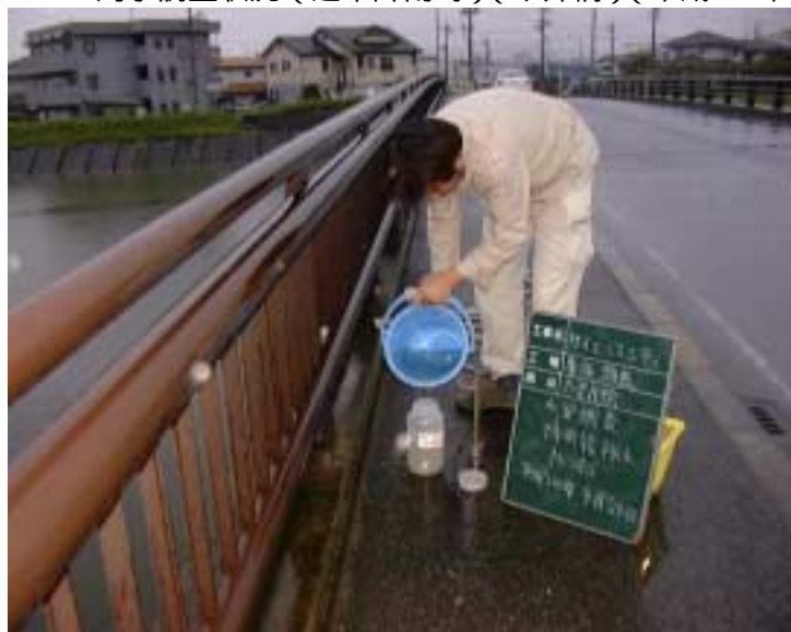
写真 4 - 6 - 24 濁水調査状況（通常降雨時）（志登茂橋）（平成 15 年 9 月 24 日）
