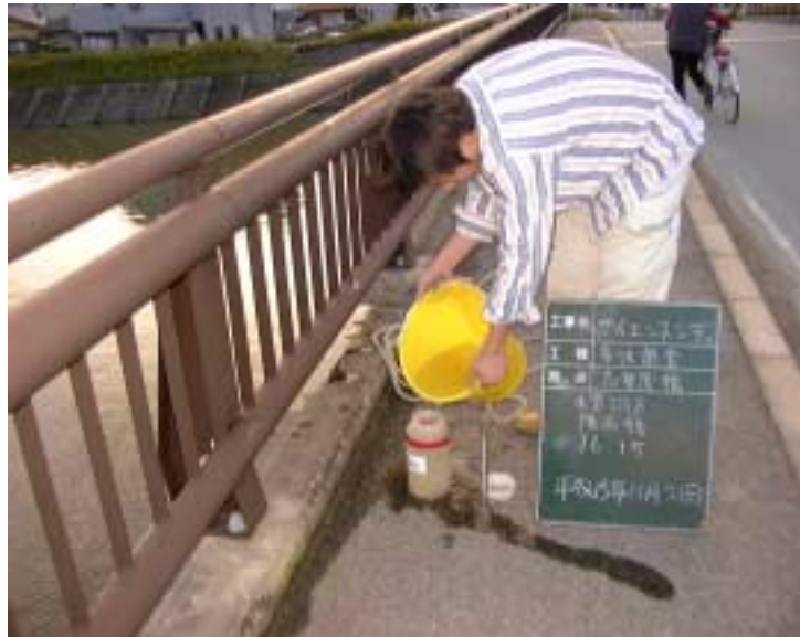
写真4 - 6 - 32 濁水調査状況(通常降雨時)(志登茂橋)(平成15年11月21日)
