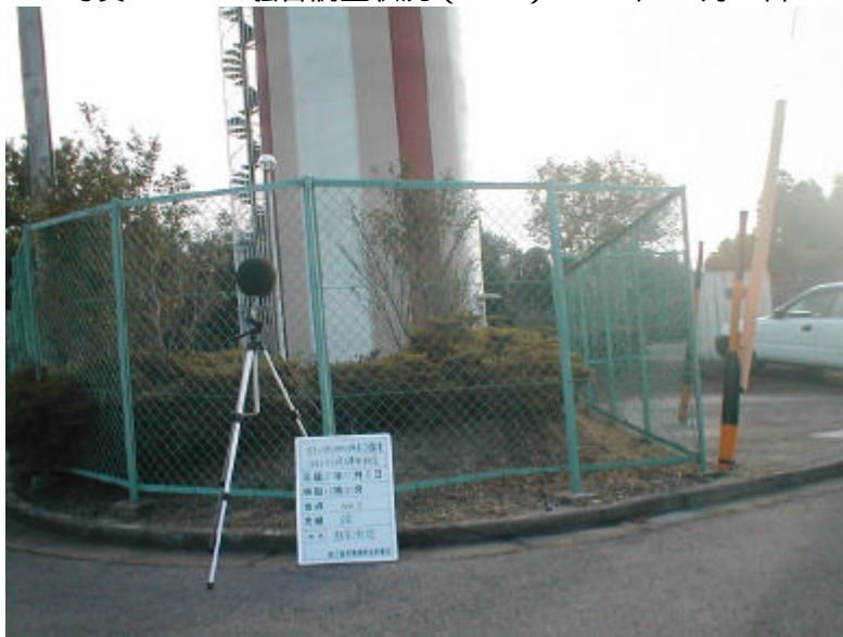
写真4 - 6 騒音調査状況 ( C ) H15年11月6日
