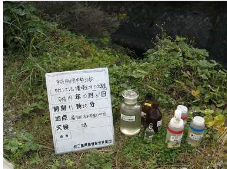
写真4 - 1 - 34 供用後排水調査状況（サイノ前田川側）（平成19年10月31日）
