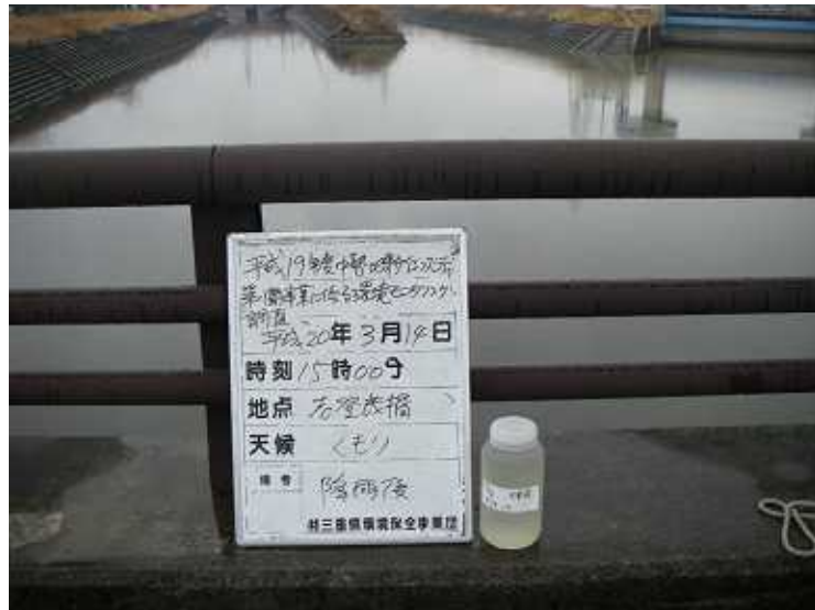
写真4 - 1 - 10 濁水調査状況（通常降雨時）（志登茂橋）（平成20年3月14日）
