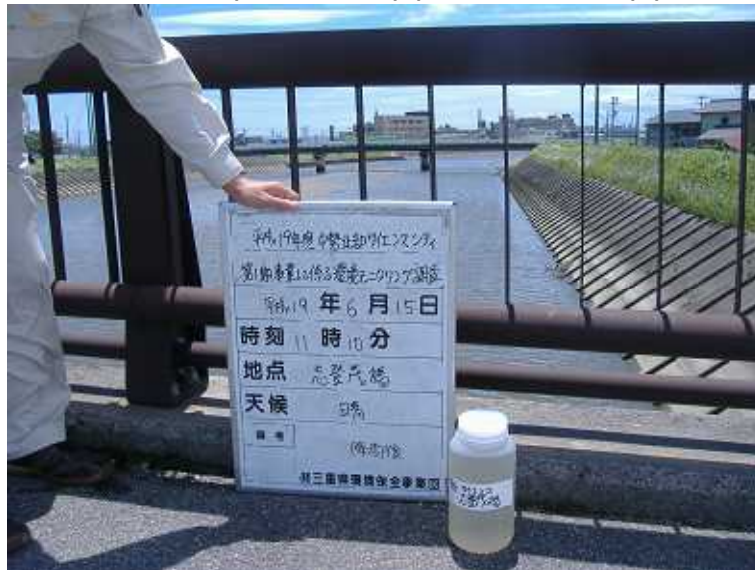
写真4 - 1 - 2 濁水調査状況（通常降雨時）（志登茂橋）（平成19年6月15日）
