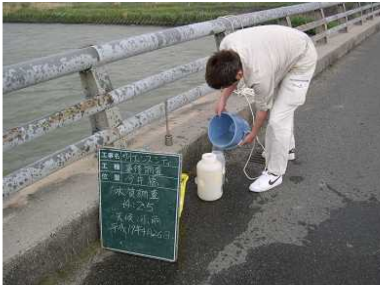
写真4 - 1 - 21 供用後排水調査状況（今井橋）（平成19年4月26日）
