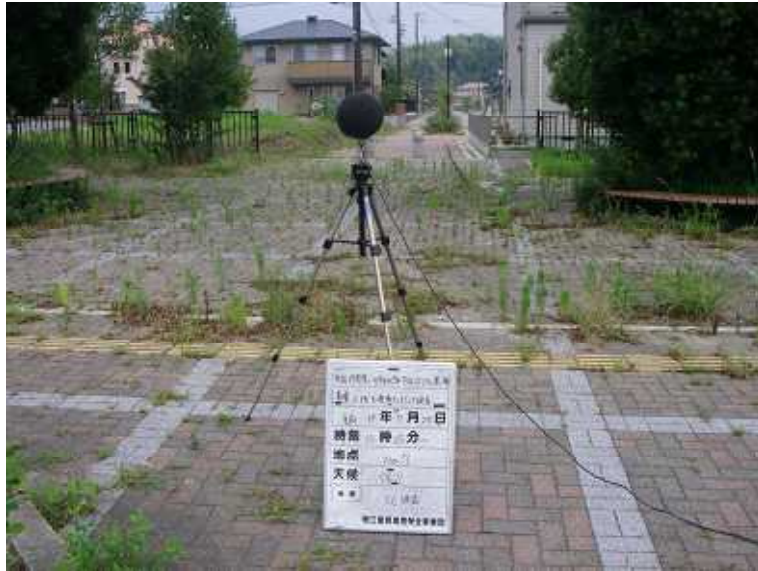
写真4-2-13 騒音測定（平成19年7月25日） 計画地内
