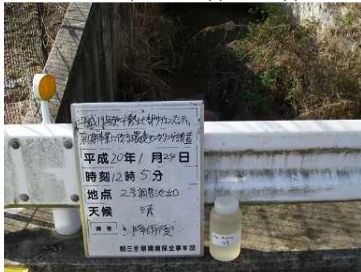
写真4 - 1 - 5 濁水調査状況（通常降雨時）（2号調整池出口）（平成20年1月24日）
