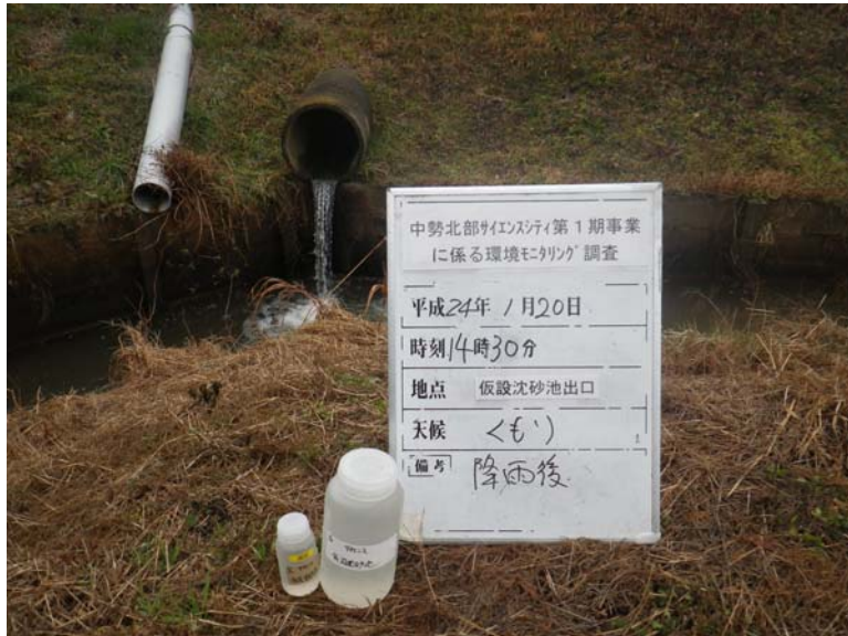
写真4-1-47 濁水調査状況（通常降雨時）（3号調整池出口付近）（平成24年1月20日）
