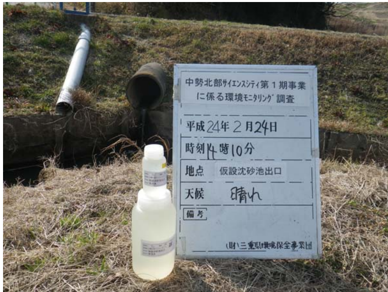
写真4-1-55 濁水調査状況（通常降雨時）（3号調整池出口付近）（平成24年2月24日）
