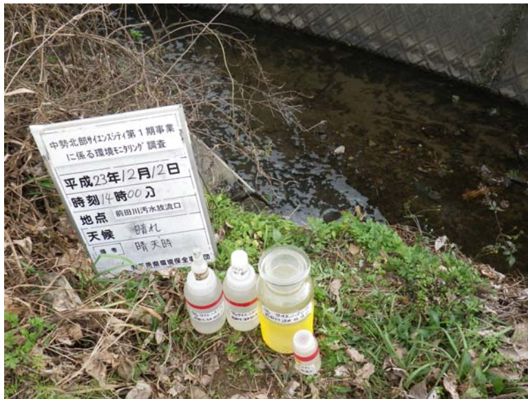
写真4-1-74 供用後排水調査状況（前田川汚水放流口付近）（平成23年12月12日）
