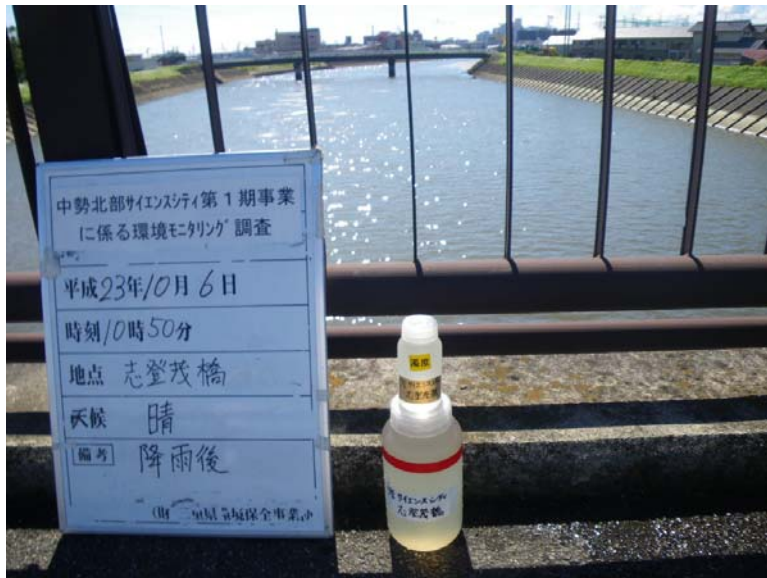
写真4-1-38 濁水調査状況（通常降雨時）（志登茂橋）（平成23年10月6日）
