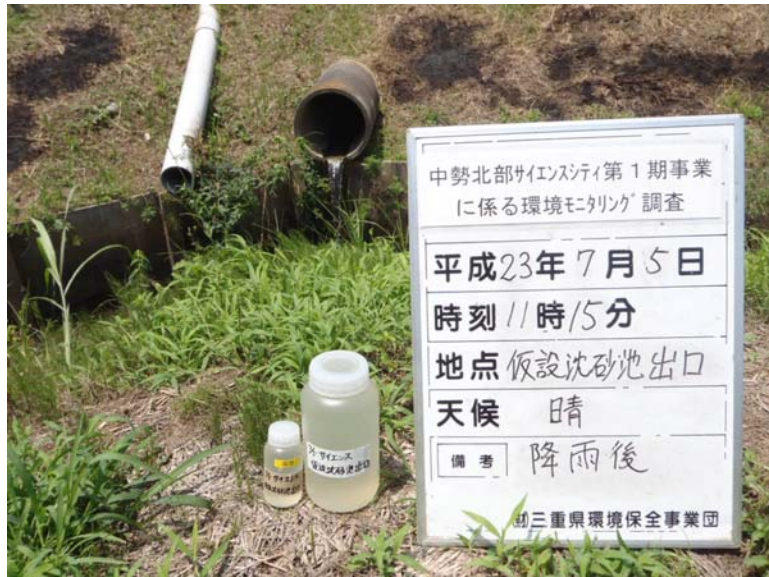
写真4-1-19 濁水調査状況（通常降雨時）（3号調整池出口）（平成23年7月5日）
