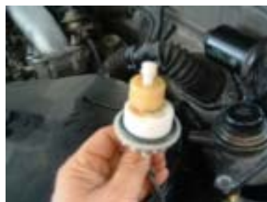
水分離器水位センサー
