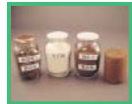
建設残土使用の 改良土
