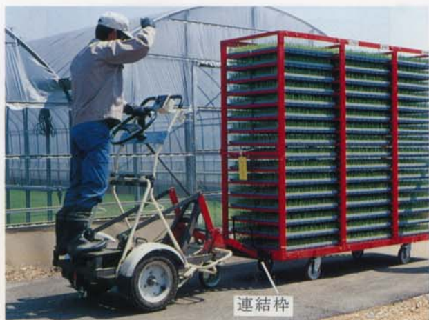
写真1 ゴルフカートを改造した運搬機
