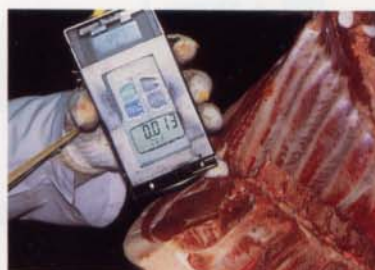
【写真2】：デジタルフォースゲージの改良による硬度の測定
