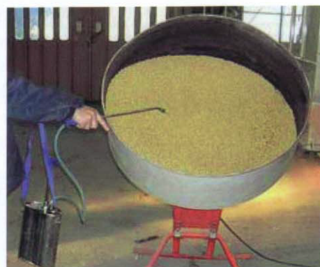
使用機：カルバーコーティングマシン 傾斜角度：約35度 処理時間：水1リットル15分
