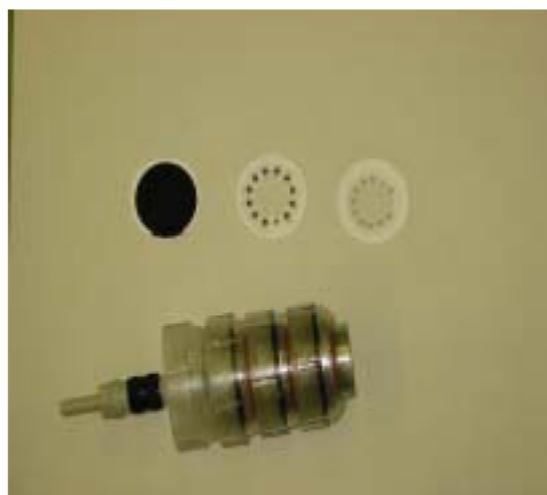
図 8 PCI 簡易サンプラー
