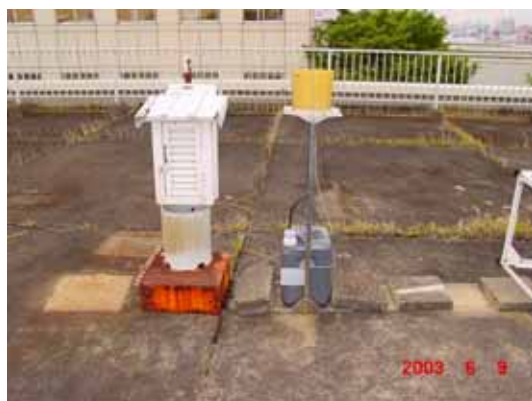
写真1 ろ過式(常時開放型捕集装置)
