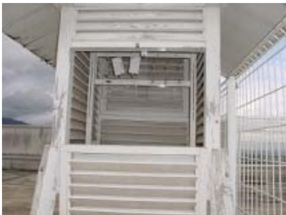
写真1 パッシブ簡易測定法で用いた暴露シェルター(百葉箱)
