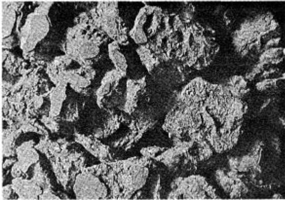
写真1 パン型ミキサにより作製したポラスコンクリートの性状(W/B=25%)
