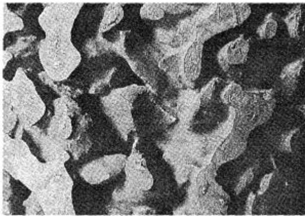
写真1 パン型ミキサにより作製したポラスコンクリートの性状(W/B=25%)
