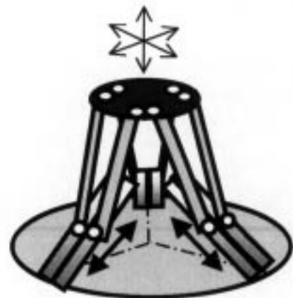
図1 6軸振動発生装置の例 (6自由度直動型パラレルメカニズム)
