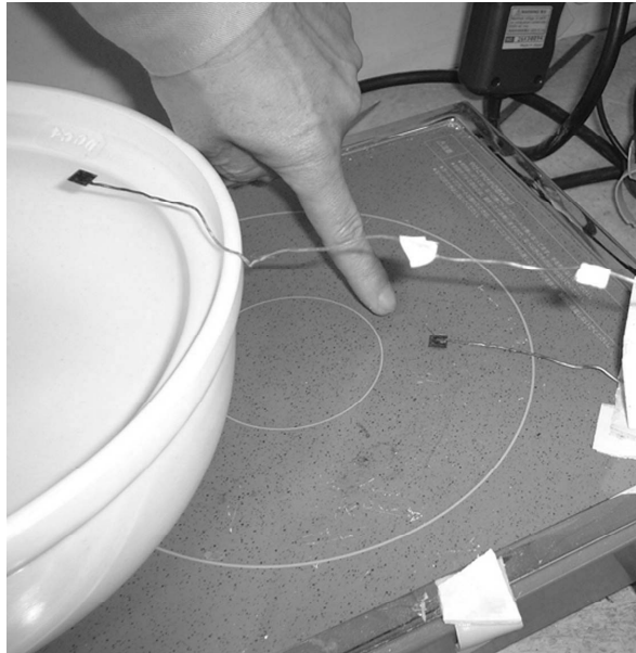
写真3 電磁調理器トッププレート温度測定
