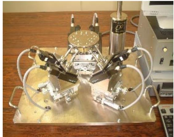
図1 試作した微細作業ステージ
