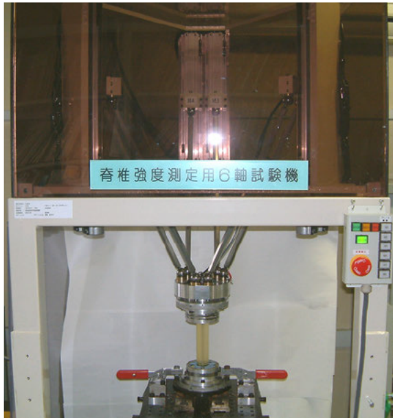
図4 脊椎強度測定用6軸試験機
