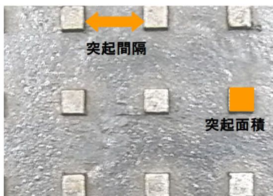
図 2 試験片の突起面積，突起間隔
