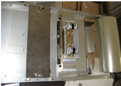
図3 ドクターブレード装置
