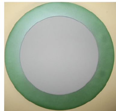
図5 電解質を印刷したアノードシート
