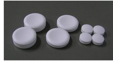
図6 試作したカルシウム錠の写真 左: 1350mg, 打錠圧28kN 中: 900mg, 打錠圧28kN 右: 250mg, 打錠圧8kN
