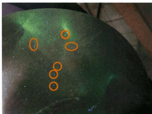
図5 磁粉探傷によるドロス欠陥の検出
