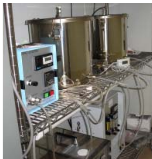
小型チャンバー法による測定
