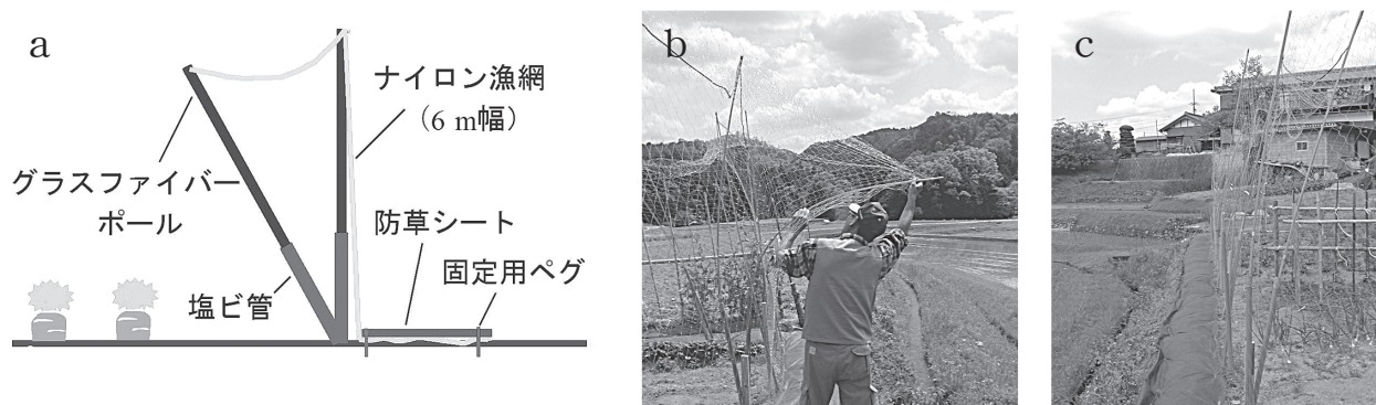
図-1. 現地適応試験に供試した簡易猿害防止柵
