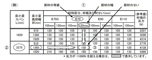
部材端の反力は、各スパンと負担幅の組合せにおける最大値を掲載していますが、おおむねE70G の材幅 135 mm (小梁は 120 mm) の値となっています。検討梁とそれを受ける他の梁又は柱の接合部の仕様によっては、反力の値が接合部の許容支持力を超えてしまう場合があるので注意が必要です。詳細については「徳島県すぎスパン表 VERSION・2」を参考にしてください。
