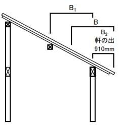
L : スパン B : 等分布荷重負担幅  $B = (B_1/2) + B_2$ B<sub>2</sub> は910mmに固定
