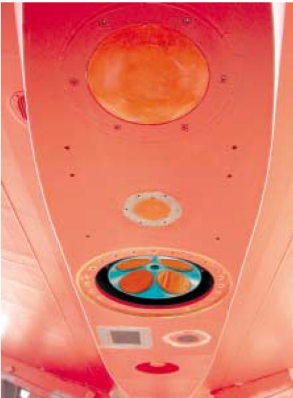
図1. 調査船「あさま」の船底ドームとADCPセンサー 写真の上が船首側方向，下が船尾方向。ADCPは中央下のカバーが外してあるセンサー。
