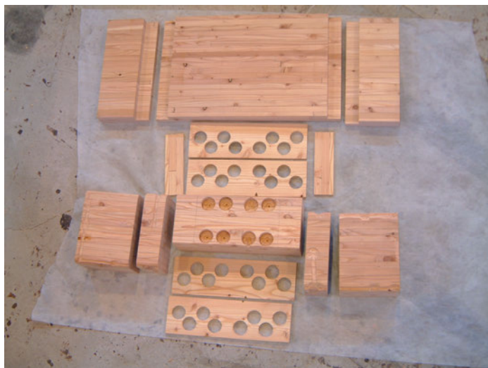
写真-2. 座彫り有り仕様の集成材パーツ
