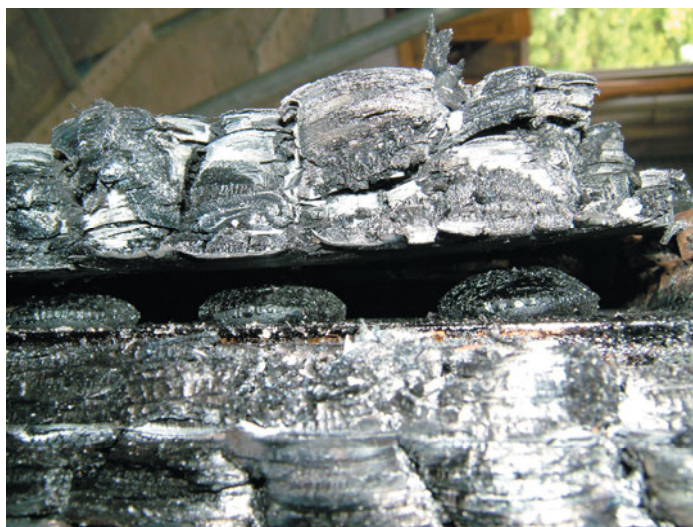
写真-8. 座彫りなし部燃烧の状況
