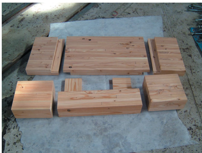
写真-3. 座彫りなし仕様の集成材パーツ
