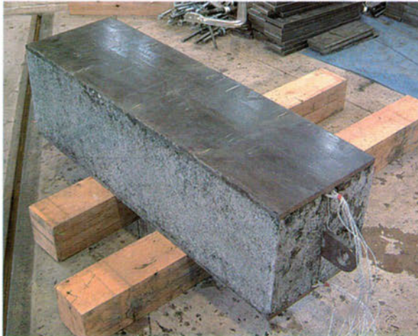
写真-2. 木片・炭・セメント材を充填した鋼材
