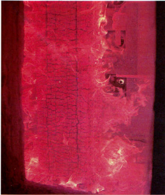
写真-8. No. 4 木材の燃焼状況
