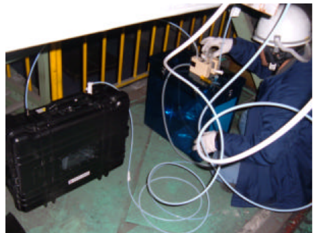
図 1 試料採取の状況 (採取容器への吸引)
