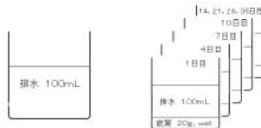
図3 分解試験の手順
