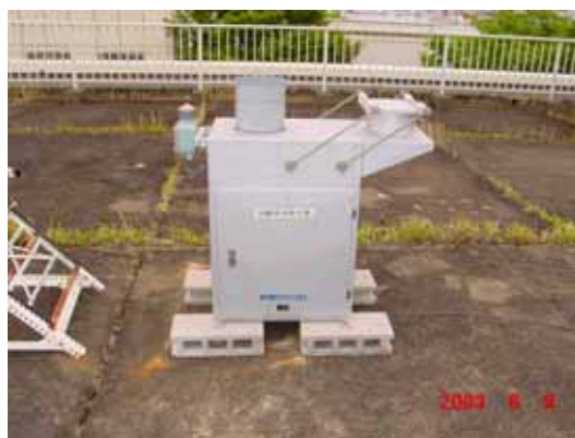
写真2 W.O.法(降水時開放型)採水装置)
