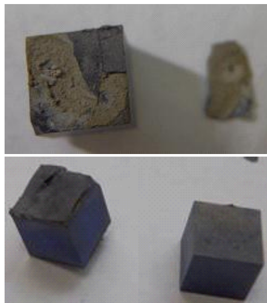
図 15 テープ剥離試験後、電極の剥離が見られた試料の外観（上：剥離した部位，下：剥離しなかった部位）
