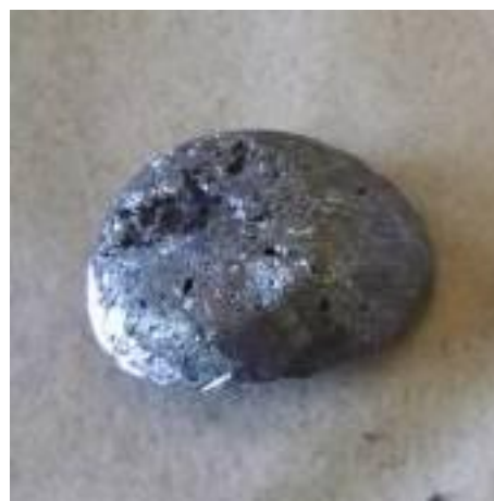
図 4 アルミナ坩堝と蓋を接着し、1100℃で合成した試料の外観
