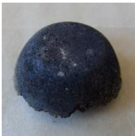
図 2 小型アルミナ坩堝中、900℃で合成した試料の外観
