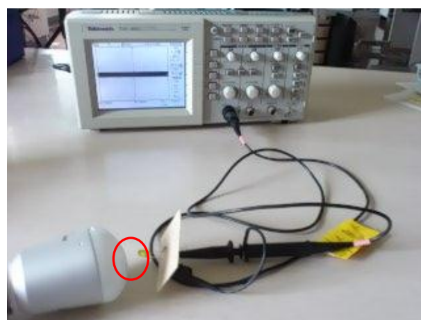
図 1 測定対象 LED 照明 (左), 単色 LED (丸印), オシロスコープ (奥)
