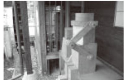
水車の力が人形に加わり、人形が動く仕組みです。
