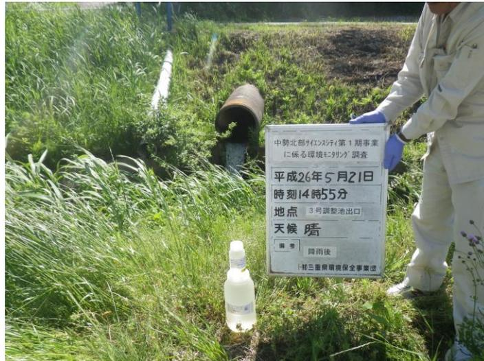
写真 4-1-7 濁水調査状況(通常降雨時)(3号調整池出口)(平成 26 年 5 月 21 日)
