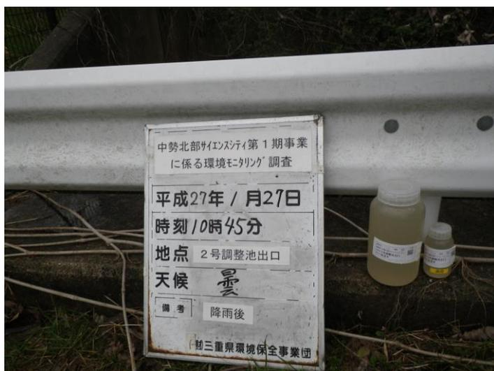
写真 4-1-49 濁水調査状況(通常降雨時)(2号調整池出口)(平成27年1月27日)
