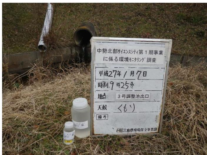
写真 4-1-43 濁水調査状況(通常降雨時)(3号調整池出口付近)(平成27年1月7日)
