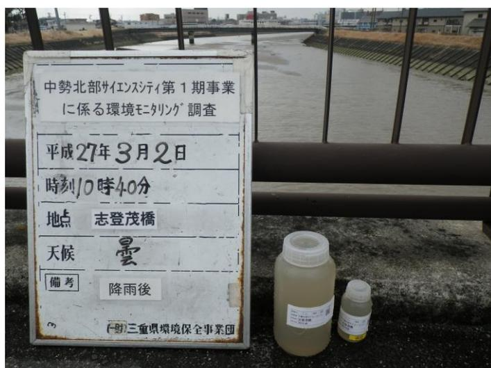
写真 4-1-54 濁水調査状況(通常降雨時)(志登茂橋)(平成 27 年 3 月 2 日)
