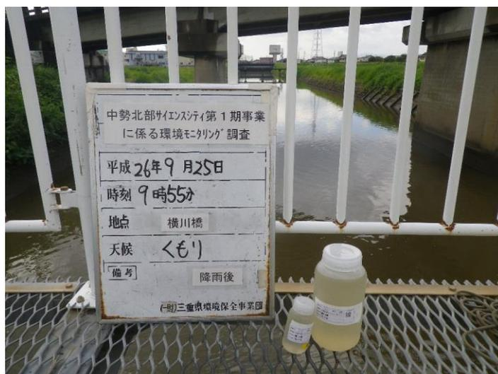
写真 4-1-28 濁水調査状況(通常降雨時)(横川橋)(平成 26 年 9 月 25 日)
