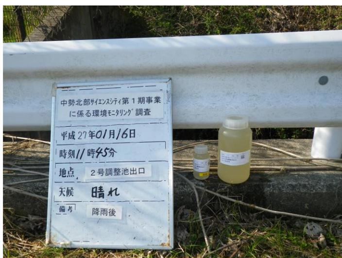
写真 4-1-45 濁水調査状況(通常降雨時)(2号調整池出口)(平成27年1月16日)
