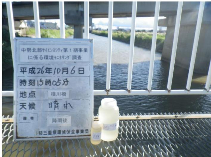
写真 4-1-32 濁水調査状況(豪雨時)(横川橋)(平成26年10月6日)
