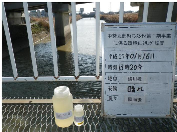
写真 4-1-48 濁水調査状況(通常降雨時)(横川橋)(平成27年1月16日)
