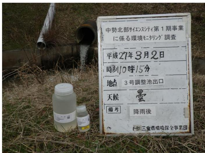
写真 4-1-55 濁水調査状況(通常降雨時)(3号調整池出口付近)(平成27年3月2日)
