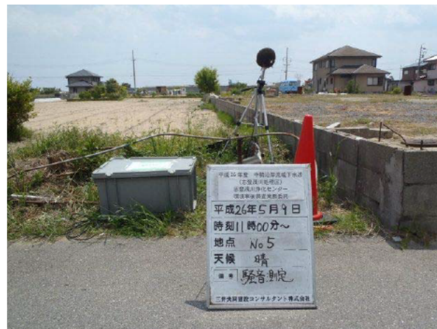
写真 2.2-1 騒音測定機器設置状況
