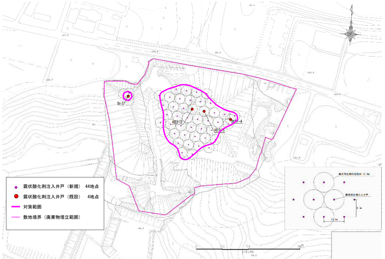
図Ⅱ－9 霧状酸化剤注入箇所平面配置図
