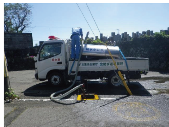
【給水車への補給作業(紀宝町)】
