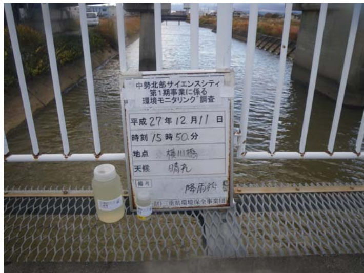
写真 4-1-44 濁水調査状況(通常降雨時)(横川橋)(平成 27 年 12 月 11 日)
