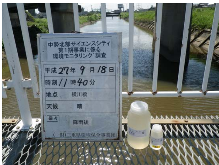
写真 4-1-28 濁水調査状況(通常降雨時)(横川橋)(平成 27 年 9 月 18 日)
