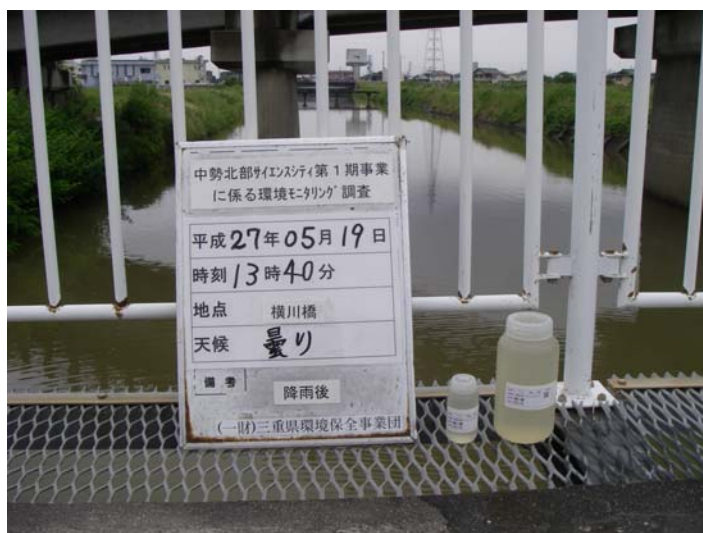
写真 4-1-4 濁水調査状況(通常降雨時)(横川橋)(平成 27 年 5 月 19 日)
