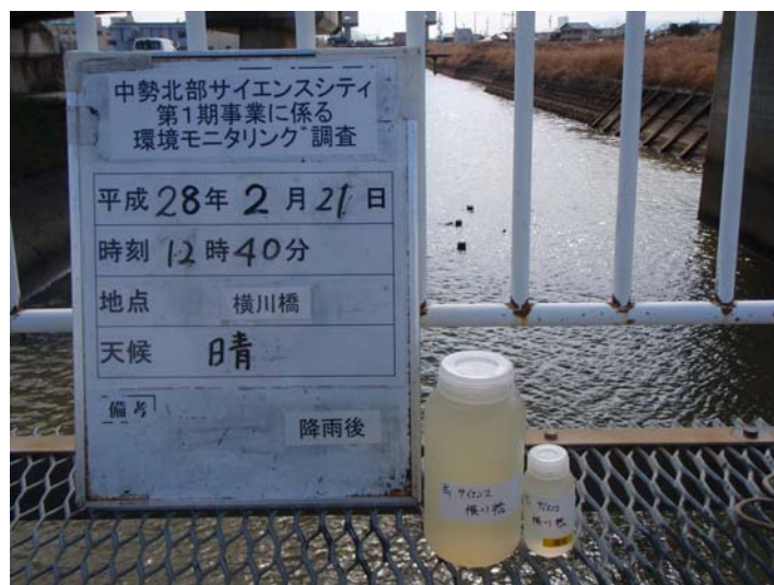
写真 4-1-52 濁水調査状況(通常降雨時)(横川橋)(平成 28 年 2 月 21 日)
