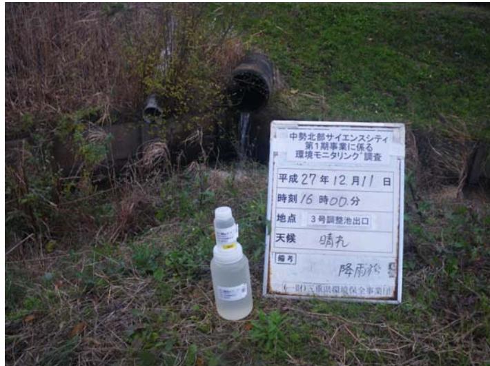
写真 4-1-43 濁水調査状況(通常降雨時)(3号調整池出口付近)(平成 27 年 12 月 11 日)
