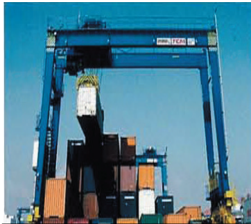
ハイブリッド型 トランスファークレーン
