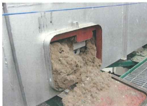
搬送コンベア内に蓄積したRDFのくず
