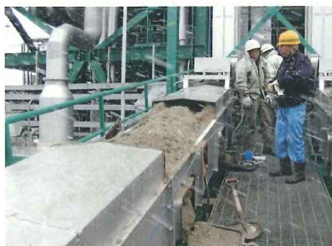
搬送コンベア内に蓄積したRDFのくず
