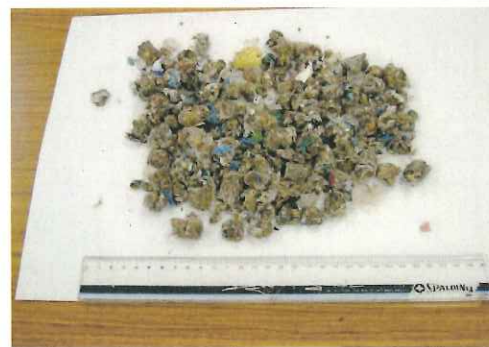
成形が不十分であるため崩れたRDF
