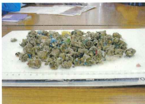
成形が不十分であるため崩れたRDF
