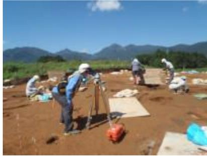
レベルという器具を使って、遺跡の海拔高度を測量します。
