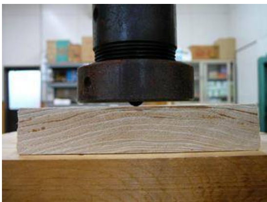
圧密化処理材の表面硬さ測定試験
