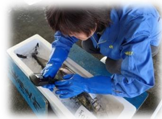
図 1 非破壊魚品質状態測定装置による脂肪含量測定
